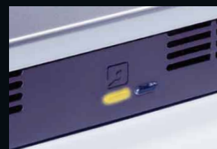
Onderhoudsweergave (hier wordt het "onderhoudssymbool" aangegeven) Geel = storing (onderhoud vereist). Geel knipperend: Status = vervuild (onderhoud noodzakelijk).
